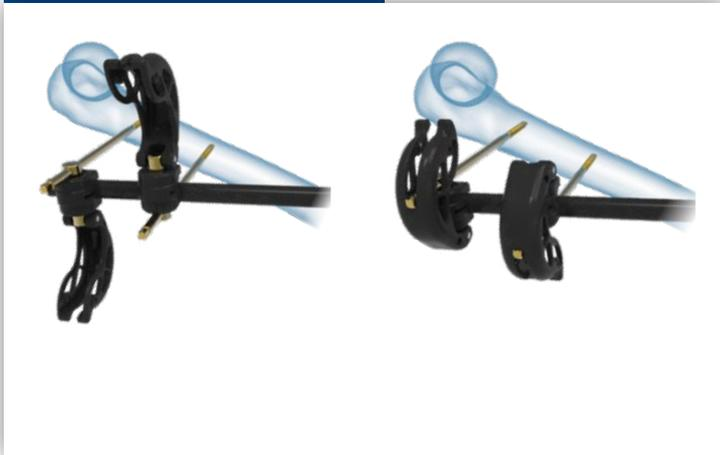
Ensamble las dos abrazaderas proximales y la primera barra.
